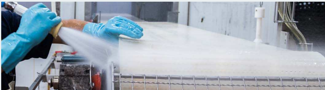
Med SKF:s lösning minskar risken att infekterat lagerfett sprids mot processområdet vid rengöring med högtryckstvätt.
